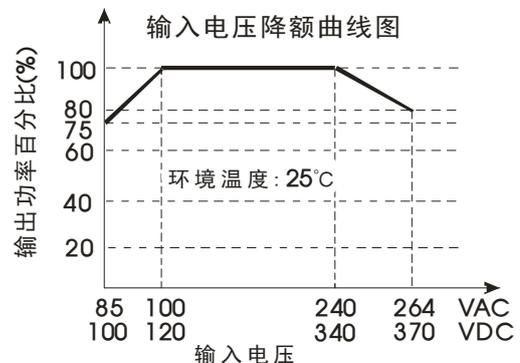
注: ①对于输入电压为 85~100VAC/240~264VAC/100~120VDC/340~370VDC 需在温度降额的基础上进行输入电压降额;
