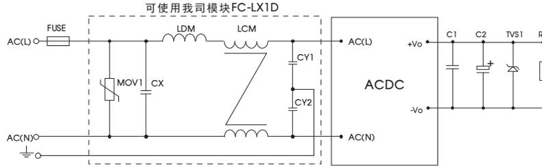
图 5: EMC 更高要求推荐电路
