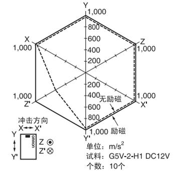
测定: 在无励磁、励磁状态下, 往3轴6方向上各加3次冲击, 测出接点产生误动作的值。
