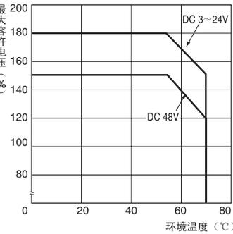
注. 最大容许电压为继电器线圈能够施加的电压的最大值。
