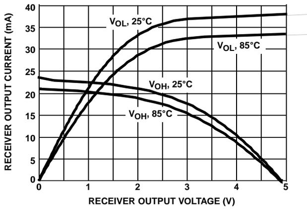
FIGURE 24. RECEIVER OUTPUT CURRENT vs RECEIVER OUTPUT VOLTAGE
