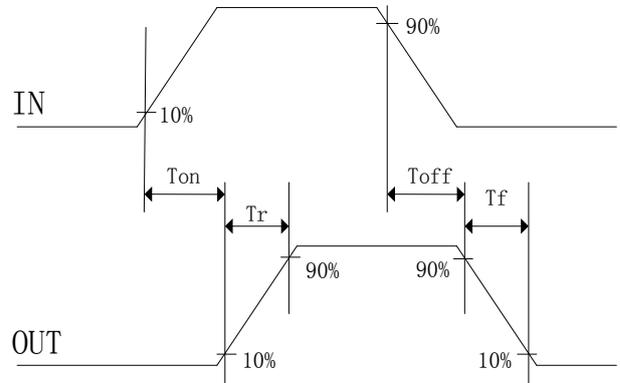
图 7-3b. 输入输出开关时间波形图
