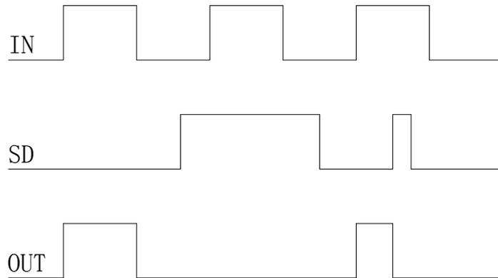
图 8-3. SD 端驱动输出关断逻辑图
